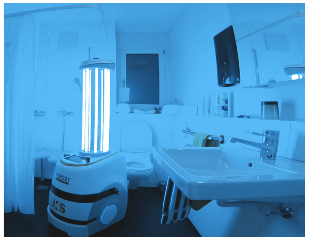
UV-C-Roboter bewegen sich frei im Raum und minimieren damit den Schattenwurf. Quelle: JKS Group, www.hero21.ch.
