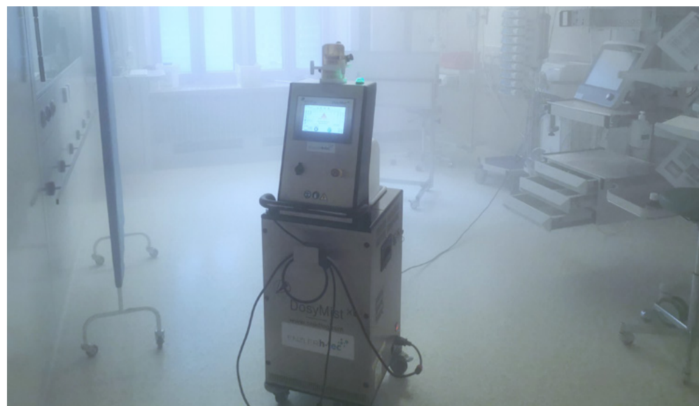
Reinigung mit vernebeltem Wasserstoffperoxid
